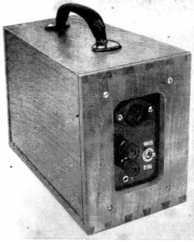
Der leicht tragbare Batteriekasten; in der rechten Stirnwand Anschlüsse und Schalter.
